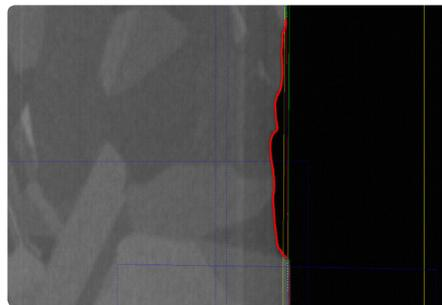
Edge fault on solar cell wafer.
