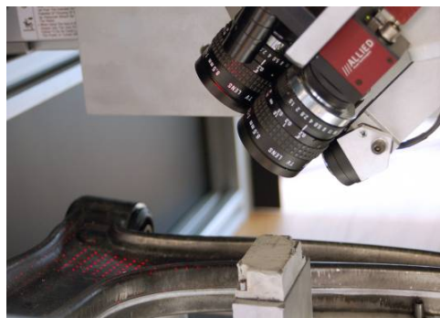
Kamera fra Allied Vision Technologies og Scorpion Vision Software® brukt i et system for 3D robotinspeksjon.
